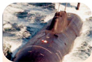
К-157 «Вепрь» — российская многоцелевая атомная подводная лодка проекта 971 «Щука-Б». Предельная глубина погружения: 600 м Автономность плавания: 100 суток Минно-торпедное вооружение: 4×533-мм ТА (28 ракет, торпед или мин), 4×650-мм ТА (12 торпед или ПЛУР) Ракетное вооружение: РК «Калибр» ПВО: ПЗРК «Стрела-3М», «Верба» * в википедия
