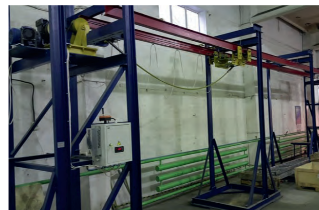
Рис. 4. Ресурсные испытания одномодульной распорки РМИД
